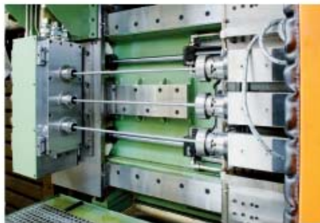
A destra: Parte terminale delle testine di foratura con ghiera di serraggio delle aste portapunta (sistema BTA). A sinistra: Slitta portaboccole con guide di scorrimento, corpo portaboccole, piastra a centri fissi posteriore (per la definizione del passo di foratura), parti terminali degli attrezzi di guida punte (boccoloni)
