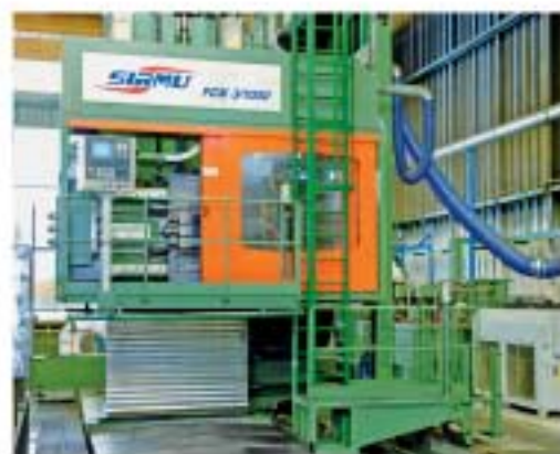
Foratrice orizzontale CNC per fori profondi FCN 3/1000 equipaggiata con tre mandrini contemporanei a interesse variabile. Sistema di foratura BTA: diametri da 16 mm a 50,8 mm. Profondità massima di foratura Z=1000 mm, Corsa sitta basamento X=8000, Corsa verticale testa Y=3500 mm, Potenza ciascun motore mandrino 37 kW
