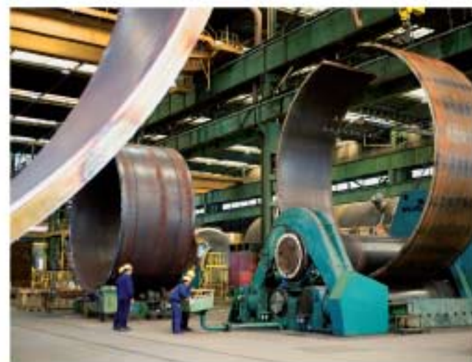
Calandratura su pressa con capacità di 7.000 tonnellate
