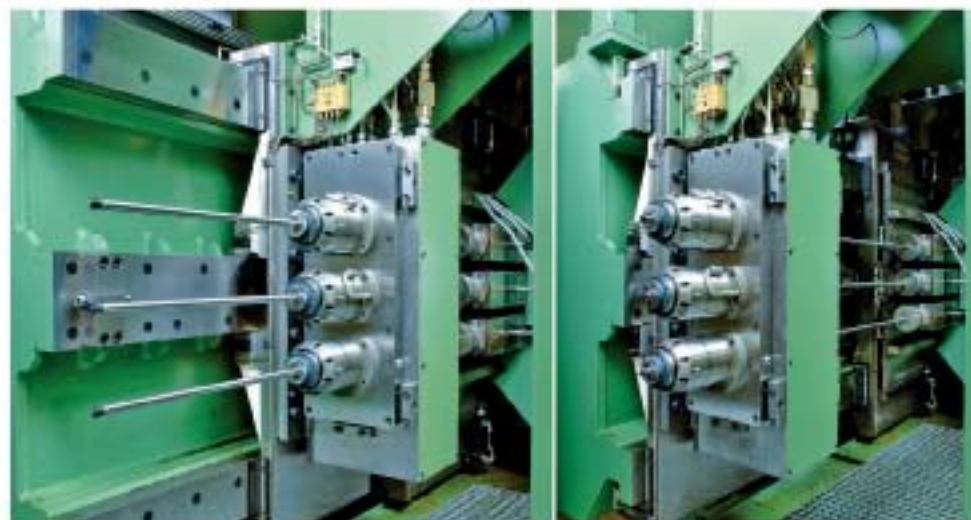
Slitta porta boccole nelle due differenti posizioni di fine corsa
