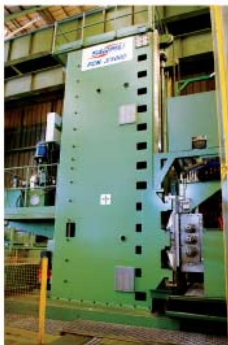
Il montante della foratrice FCN 3/1000 è realizzato in acciaio elettrosaldato stabilizzato ed è dotato di una struttura alveolare di notevole rigidità torsionale. Le guide di scorrimento della testa sono temprate e rettificate
