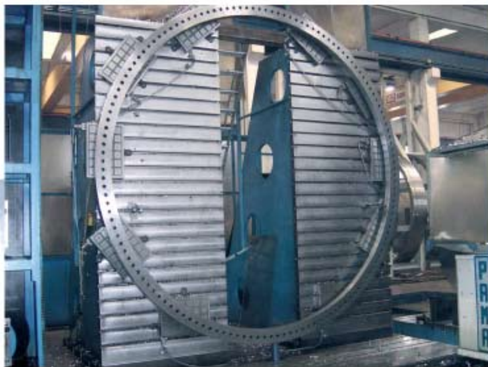
Componente per la produzione di energia eolica, lavorato sulla Speedram 2000. Le lavorazioni di fresatura possono essere realizzate fino all'altezza di 5.000 mm (asse Y - Testa)
