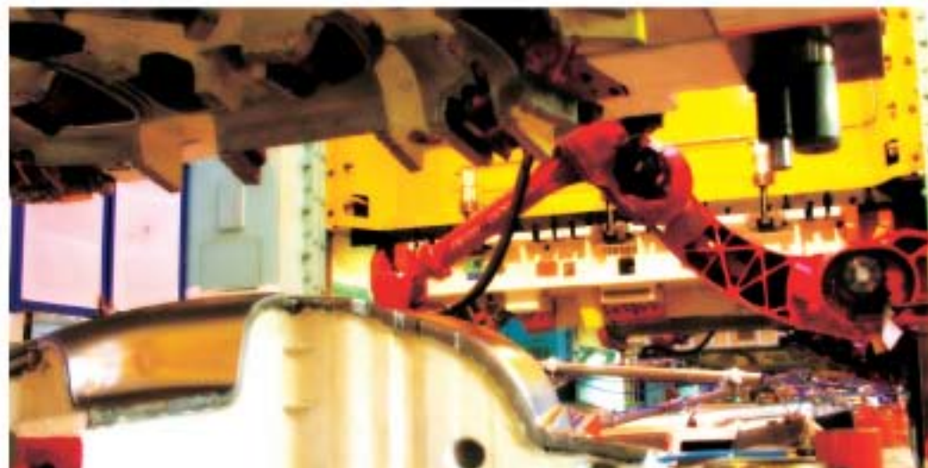
Qui la struttura cinematica del robot Comau Smart PressBooster è radicalmente cambiata: la rigidità strutturale è cresciuta con utilizzo di nuovi materiali e di un nuovo design, e il raggio d'azione è quasi raddoppiato. A fianco - Riducendo al minimo le operazioni di manutenzione, oggi il robot industriale è uno strumento affidabile e sicuro, che garantisce un ritorno dell'investimento in tempi rapidissimi.
